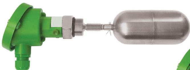
La variation de niveau de liquide fait légèrement monter ou descendre le flotteur. En franchissant l'horizontale vers le haut, le flotteur actionne un microrupteur à l'aide d'une tige.
